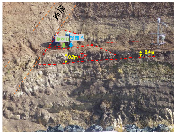
写真-5 計器設置状況とすべり面の分布
