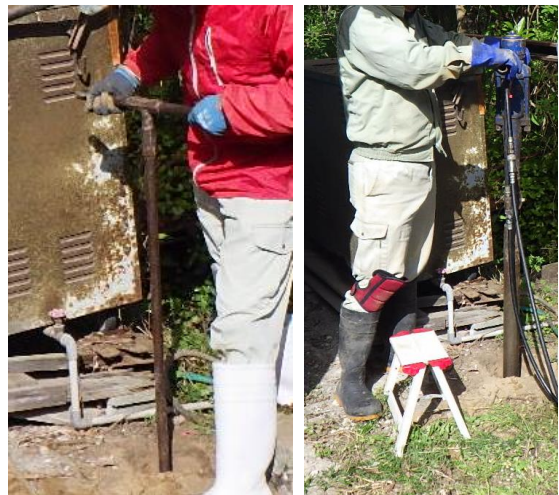
写真-1 使用機材(左:ハンドオーガー, 右:機械式簡易ボーリングマシン)
