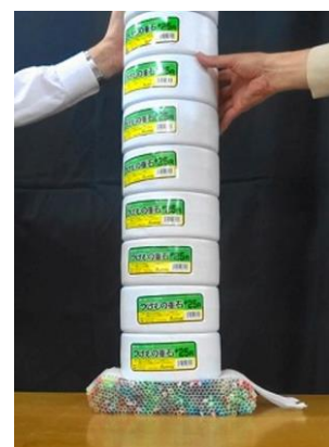
写真-5 重り25kgfを載せても沈まない
