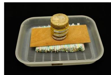
写真-4 重り4kgfを載せても沈まない
