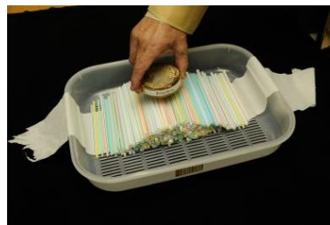
写真-1 ストローの山に重り(約1kgf)を載せる
