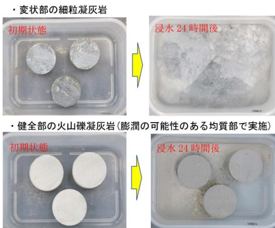
写真-3 変状部と健全部の浸水崩壊度試験結果比較
