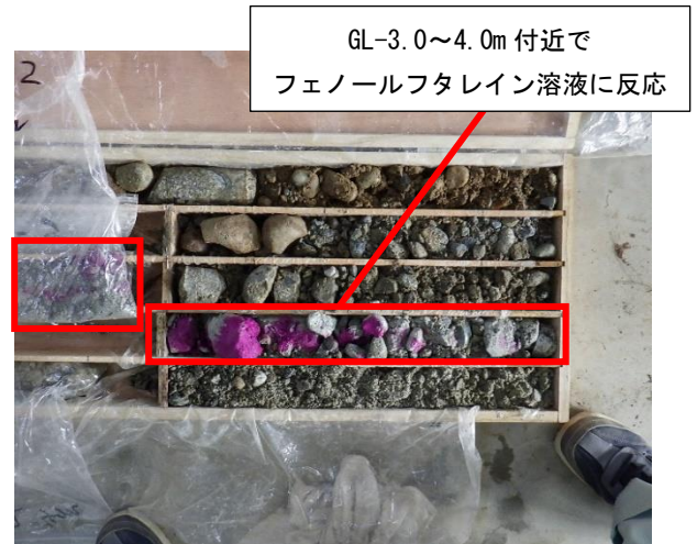
写真-2 VB-2地点 (P1橋脚付近) のボーリングコア
