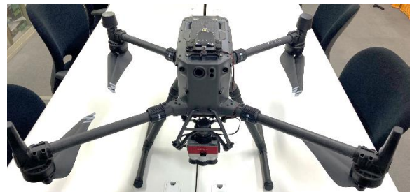
図-2 使用したUAVとマルチスペクトルカメラ
