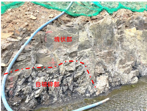
図-1 安山岩の塊状部と自破碎部
