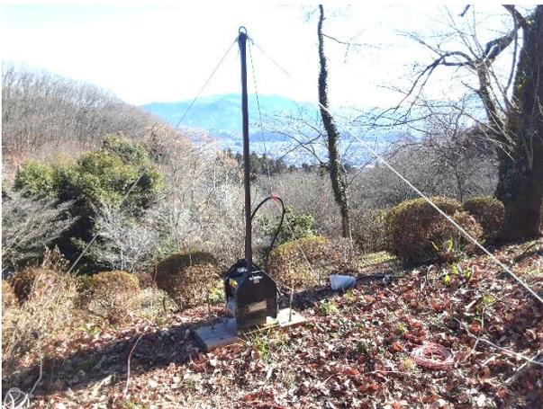
写真-2 重錘落下装置
