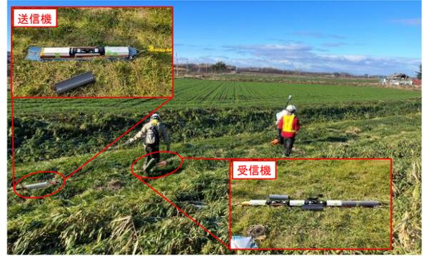
図-1 牽引式電気探査の測定状況例
