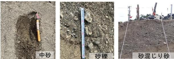
写真-1 開削断面および各築堤履歴の土質状況
