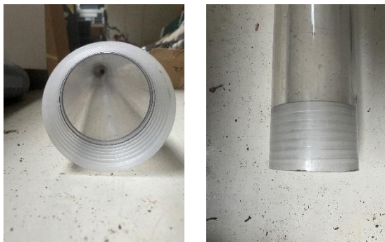
写真-1 透明管(φ76mm ポリカーボネート製)について
