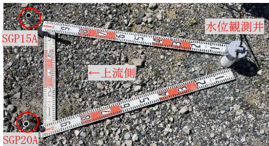
図-5 水位測定管の配置状況
