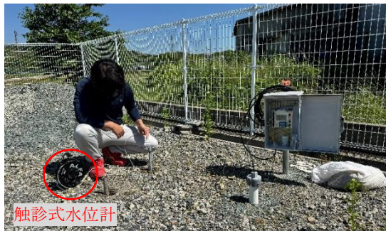
図-6 水位測定状況
