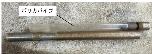
写真-1 内管をポリカパイプに変更した二重管サンプラー
