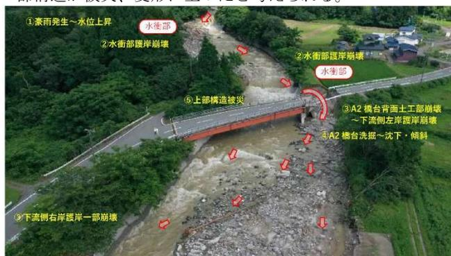
図-7 UAVによる被災した橋梁の周辺状況
