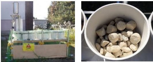
写真-1 実現象再現溶出試験状況
