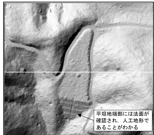
図-3 山地部における人工地形箇所の抽出の例 (0.5mDEM から作成した起伏陰影図)
