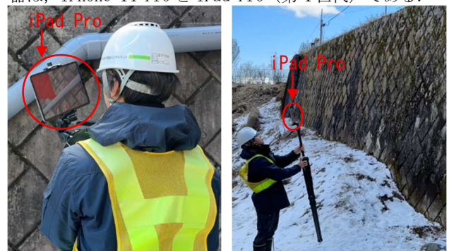
写真-2 LiDAR スキャナー計測状況
