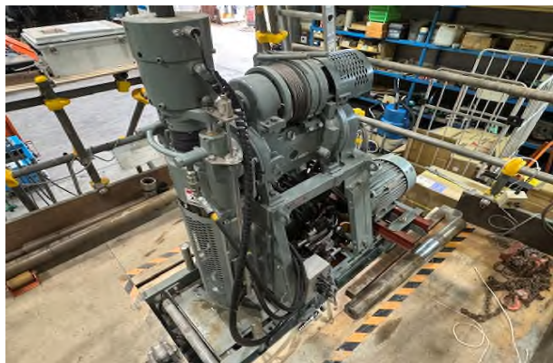
写真-1 半自動ボーリングマシン
