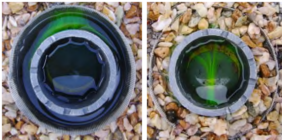
図-3 可視化した観測孔内の水の流れ
