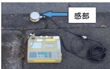
写真-2 振動加速度レベル計の外観
