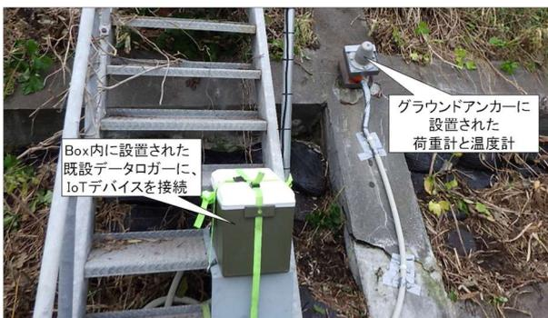
図-4 IoT デバイスの現場設置状況
