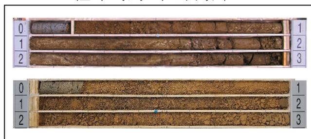
図-2 モルタルおよび土砂部の採取コア
