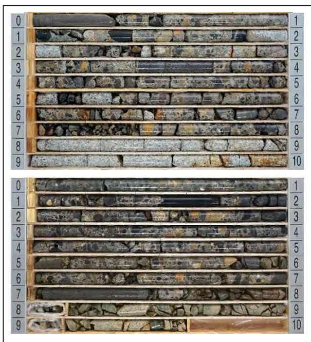
図-1 コンクリートおよび岩盤部の採取コア
