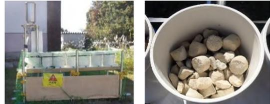
写真-1 実現象再現溶出試験状況
