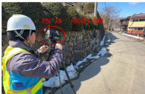
写真-3 赤外線カメラ撮影状況
