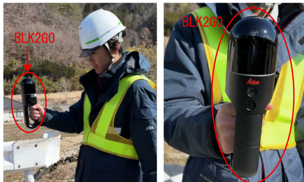
写真-1 スラムレーザー計測状況
