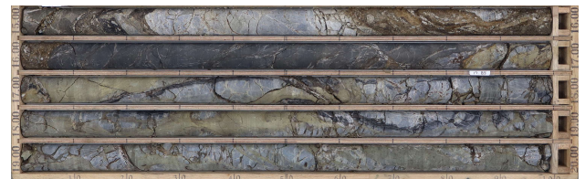
図-1 高角度傾斜により複雑な地質構造のコア
