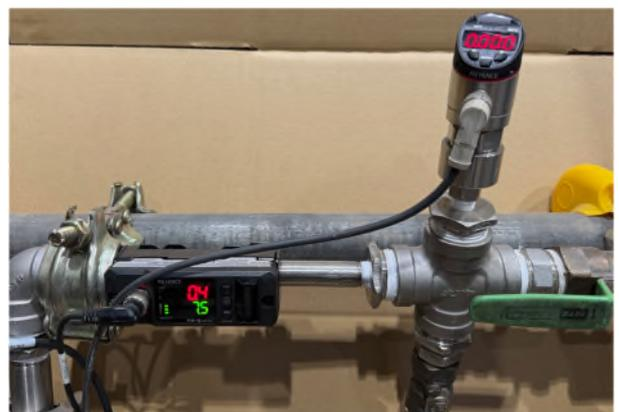
写真-4 送水流量計、送水圧力計
