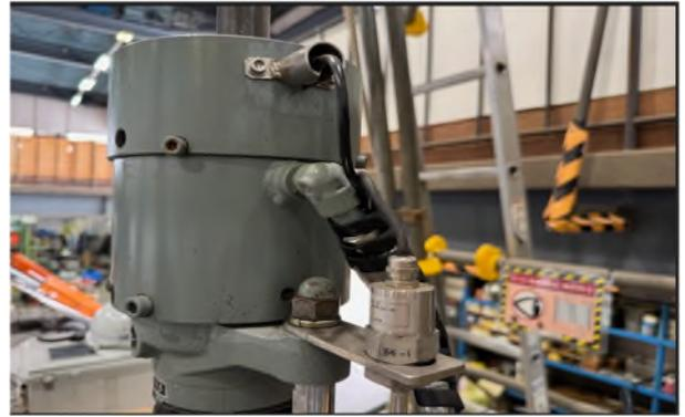
写真-2 回転センサーと磁歪センサー
