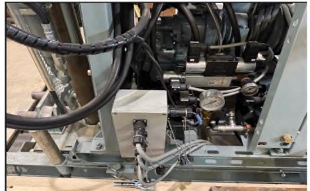
写真-3 油圧計および油圧コントローラ
