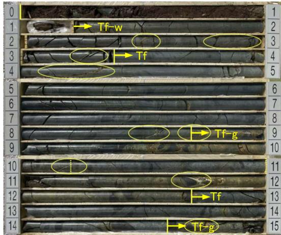
図-3 R6BV-1コア写真(Tf-w:風化岩, Tf-g:変質帯, Tf:玄武岩, ○:変質帯層理面)
