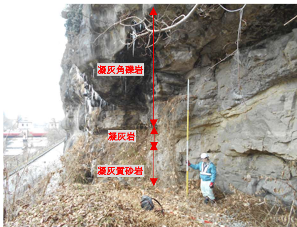
図-1 現地踏査により確認されたオーバーハング部
