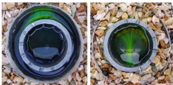
図-3 可視化した観測孔内の水の流れ
