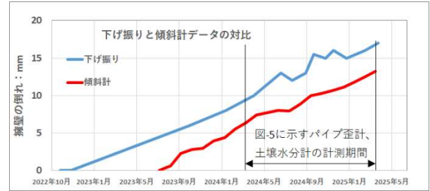
図-6 下げ振りデータと傾斜計データの対比
