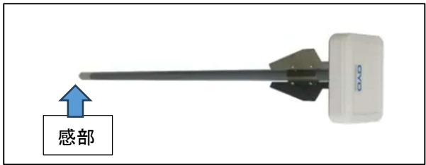
写真-1 表面傾斜計の外観
