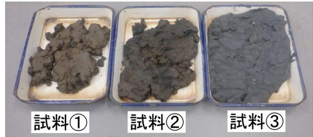
写真-2 試料土の写真(粘性土)
