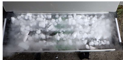
写真-2 運搬時における試料の凍結
