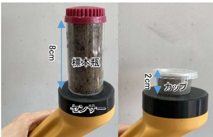
写真-1 測定状況（左：標本瓶試料、右：調整試料）
