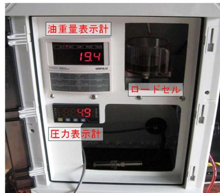
図-2 載荷圧・変位量のデジタル表示化
