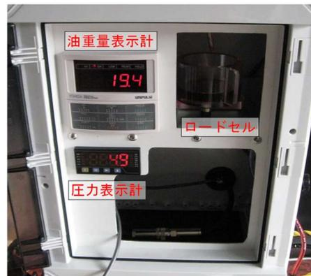
図-2 載荷圧・変位量のデジタル表示化
