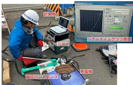
図-4 改良(PC収録システム)完成後のKKT測定状況
