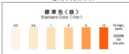
図-1 パックテストによる鉄濃度判定例
