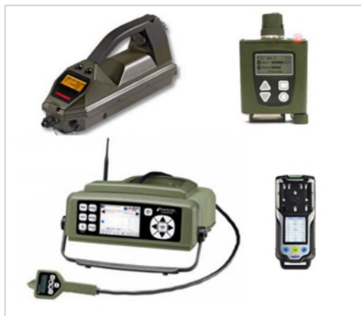
写真-4 携帯型化学剤検知器
