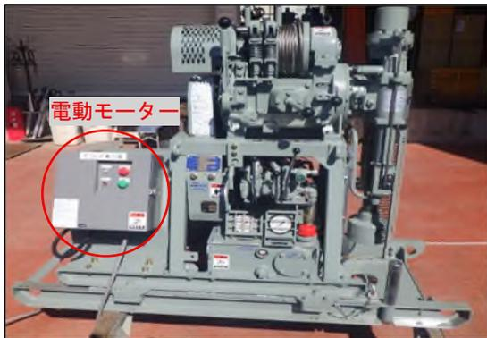
写真-3 電動モーター駆動のボーリングマシン
