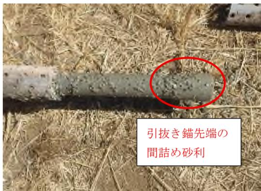
写真-4 引抜き錨先端の間詰め砂利
