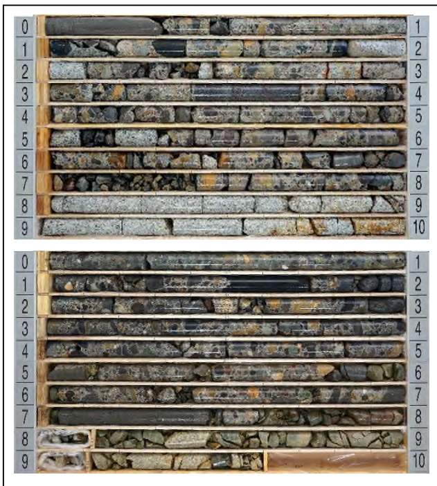
図-1 コンクリートおよび岩盤部の採取コア (上:ボーリング 下:コアドリル) 1)
