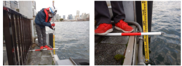
図-6 乾舷高の計測
