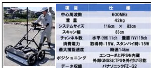
図-1 本調査で使用した地中レーダー探査機器の様子
