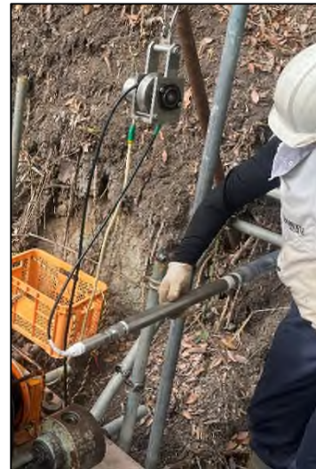
図-7 水平孔の撮影状況
