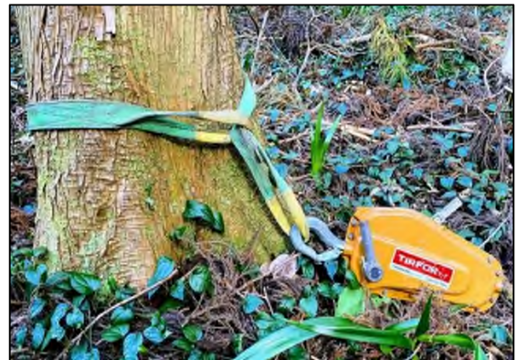
写真-2 固定点との連結例
