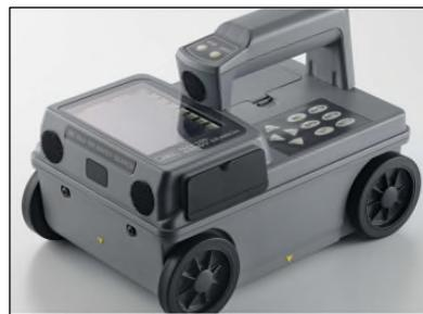
写真-5 鉄筋レーダー測定器
