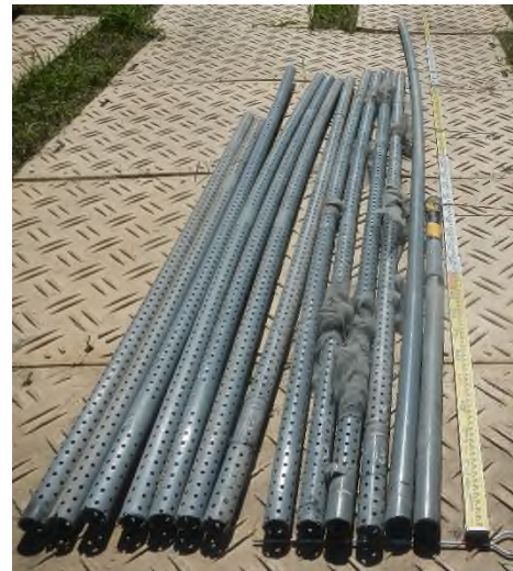
写真-6 塩ビ管の検尺
