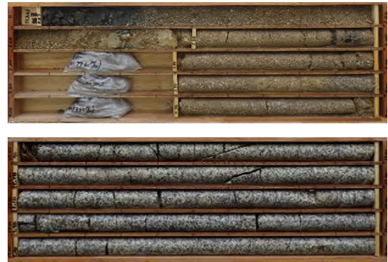
写真-3 新技術で採取したボーリングコア写真
