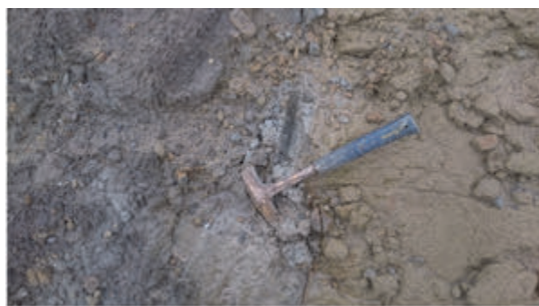
写真2. スレーキングした泥岩
