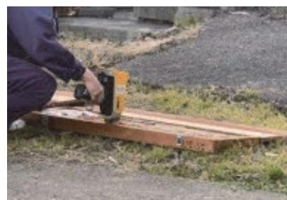
図 6 ハンドヘルド XRF の測定状況
