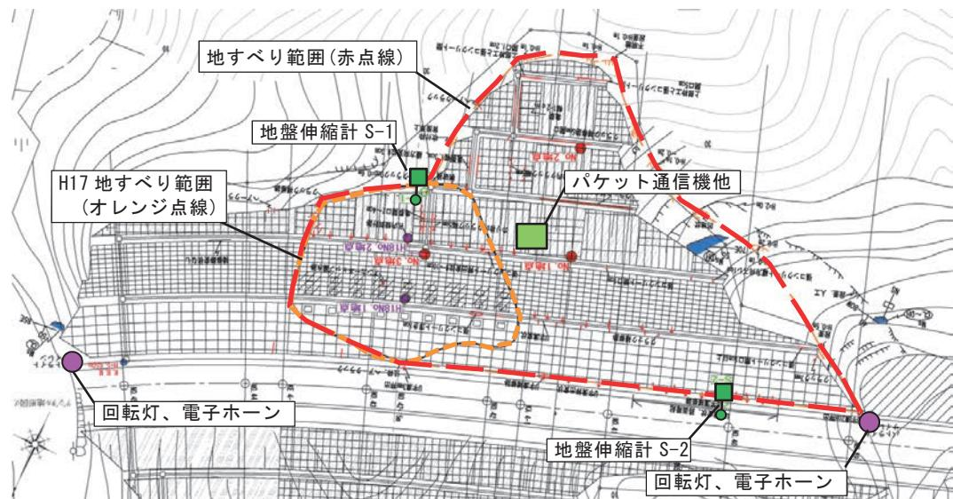
図 5 計測監視システム配置図
