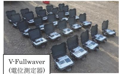
図9 三次元電気探査測定装置
