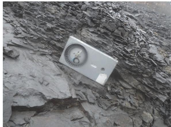
写6. 泥質岩の地質構造(流れ盤)
