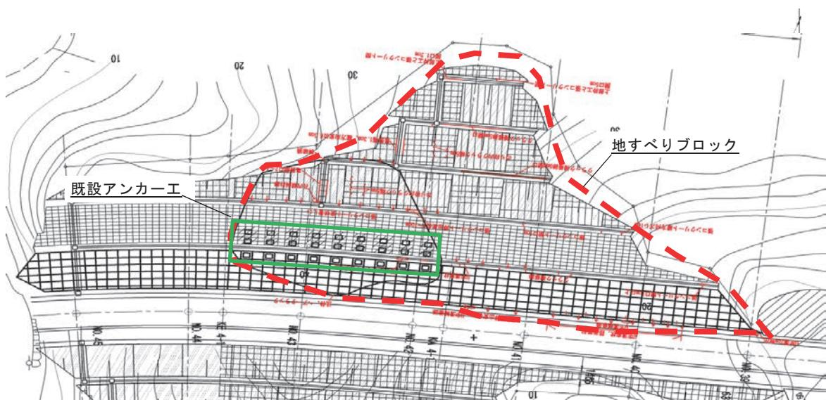
図 1 切土のり面内、地すべりブロック平面図
