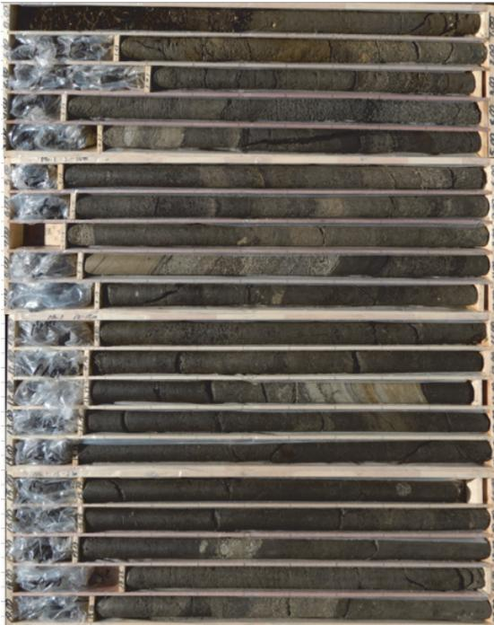
図6 起点側坑口部の天盤のコア写真
