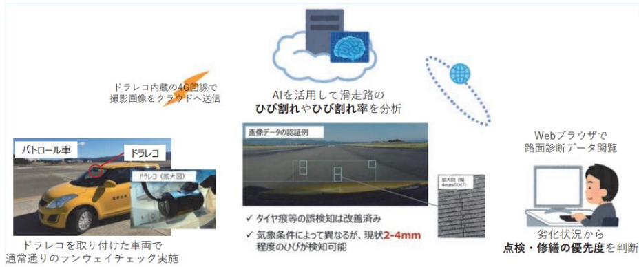
図 5-36 AI を活用した空港滑走路点検の高度化・効率化のイメージ
