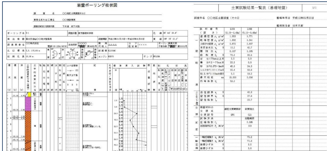
(左) ボーリング交換用データ (XML:DTD0500) をビューアで図化した例 (右) 土質試験結果一覧表データ (XML:DTD0500) をビューアで図化した例 図 6-29 ボーリング交換用データ、土質試験結果一覧表データの図化例
