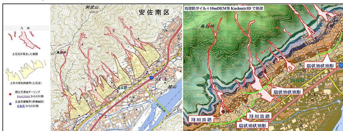
（左）土砂災害危険箇所図＋土石流範囲図 （右）標高段彩図＋土石流範囲図
