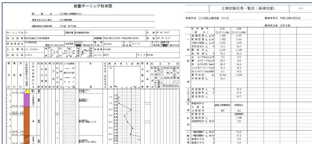
（左）ボーリング交換用データ（XML:DTD400）をビューアで図化した例
