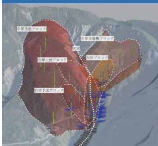
地すべりブロックの3次元モデルと集水孔配置計画 (「地質と調査」139号, 2014 一部加筆)
