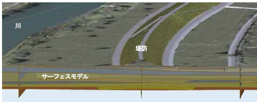
河川における3次元地質モデルの利用 (荒川調節池工事事務所 HP に加筆)
