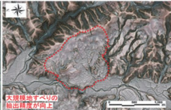
航測レーザー計測結果による陰影図
