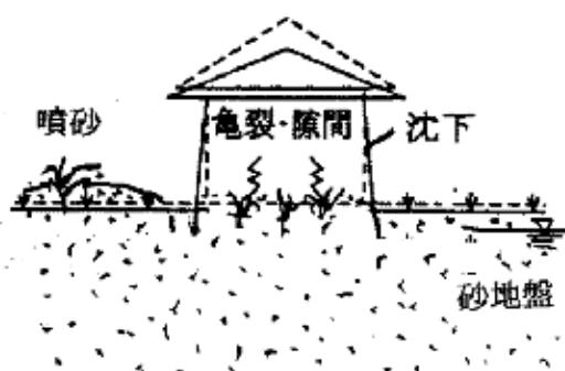
図 5.3.8 地下水位の高い砂地盤
