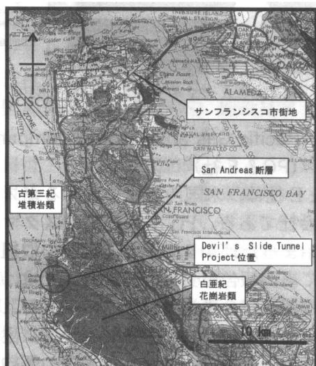
図 4 Devil's Slide Tunnel Project 周辺地質図<sup>1)</sup>
